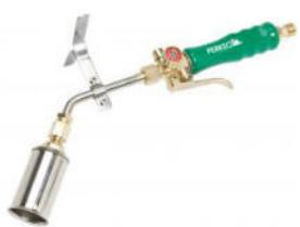
mit 40 mm Brennerkopf, 125 mm langem Brennerrohr aus Edelstahl, Aufstellfuß und Sparautomatik-Griffstück mit fest eingestellter Zündflamme gem. BG-Vorschrift.
