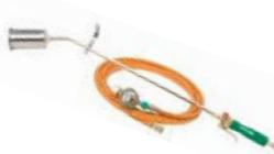
komplett mit Hochdruckschlauch bis 30 bar, fest eingestelltem Propanregler 4 bar mit Kombi-Anschluss und Schlauchbruchsicherung, 60 mm Hochleistungs-Brennerkopf und 600 mm langem Brennerrohr aus Edelstahl, Aufstellfuß und Sparautomatik-Griffstück mit fest eingestellter Zündflamme gem. BG-Vorschrift.
