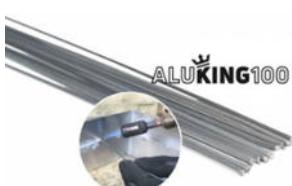
Aluminium Lötstäbe nach DIN EN ISO 3677 zum Weichlöten von Aluminium mit der einfachen Propanflamme! Fertige Lötnaht mit Zugfestigkeitswerten höher als Grundmaterial. Alle gängigen Materialstärken im Spengler- und Klempnerbereich lötbar, auch geeignet zum Löten von Aluminiumlegierungen.
