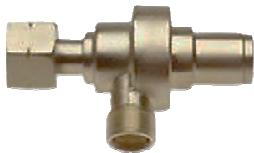
**fest eingestellt auf 1,5 bar**, mit integriertem Sintermetallfilter zum Schutz vor Versulzung der Lötgeräte bei umgekippter oder frisch befüllter Propan- Flasche.
